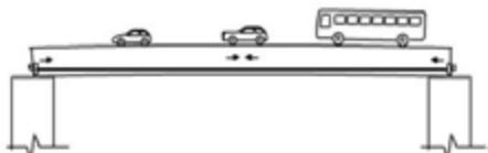
Avec l'augmentation des charges, l'ouvrage peut supporter une légère incurvation vers le bas. Aucune fissure n'apparaîtra aussi longtemps que la partie inférieure restera en compression.
